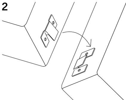
Heben Sie die Elemente beide gleichzeitig an. Senken Sie sie dann gleichmäßig ab! Die Beschläge greifen jetzt ineinander und halten die Elemente fest (durch Anheben ist die Verbindung leicht wieder lösbar).
