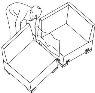
Das Eckelement und ein anschließendes Element dicht zusammenstellen und ausrichten. Immer ein Stück unserer Transportfolie zwischen die Elemente legen! Damit gleiten die Elemente besser! Diese Gleithilfe verhindert auch, dass sich die Bezüge durch Reibung gegeneinander aufschieben und unerwünschte Falten bilden. Wegen des Schwerpunkts der Möbel müssen sie unbedingt hinten leicht angehoben werden.
